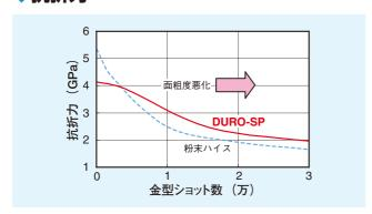
DURO-SPは、粉末ハイスに比べ耐摩耗性が高いため、 面粗度が悪化しにくく、靱性の低下が少ない。
