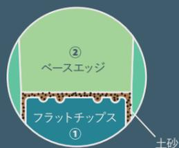
①のフラットチップスと②のベースエッジの隙間に土砂が詰まり、バケット内の土砂が抜け落ちにくくなります。
