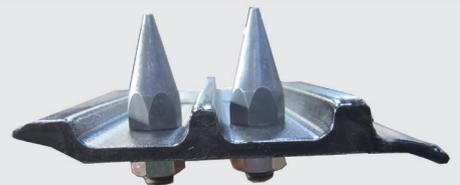
ゴムパット取付用の穴にシュー滑り止めを装着し、シュープレートの下からナットとハードワッシャーで固定します。
