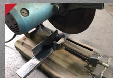
① タングステンのない裏面を切断
