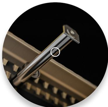
強度アップ、コスト削減を目的とし、ブッシュを採用しました。純正はベアリングを使用。(IC45-2)
